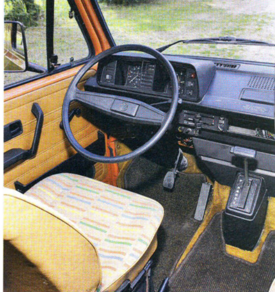
Im Vergleich mit späteren T3-Typen wirkt der Westfalia von 1980 dünn und sparsam. Die Dreistufenautomatik war ein selten bestelltes Extra
