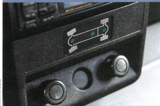
Zug um Zug lassen sich an der Mittelkonsole die (natürlich aufpreispflichtigen) Differenzialsperren für Vorder- und Hinterachse aktivieren
