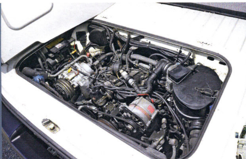
Maximal motorisiert: Unter jeder Menge unübersichtlich verlegter Kabel und Schläuche steckt der 2,1 Liter große und 112 PS starke Wasserboxer
